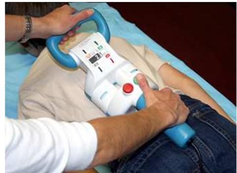
Figure 4: Utilisation du contrôleur externe du dispositif MAGEC
